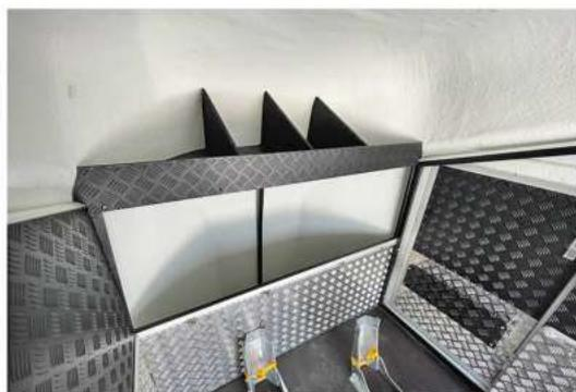
Estructura interior frontal con un separador de chapa ideal para guardar las botas, Kärcher, etc.. Con chapa de aluminio y un carril con 4 fijaciones. En la parte superior una bandeja superior con 3 compartimentos para cascos, forrado con moqueta/goma.
